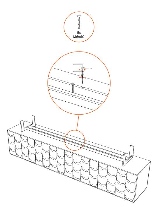
Avvitare la base sul corpo dell'armadio. Fai lo stesso sul lato sinistro e destro della base. | Screw the base to the cabinet's body. Do the same on the left and right side of the base.
