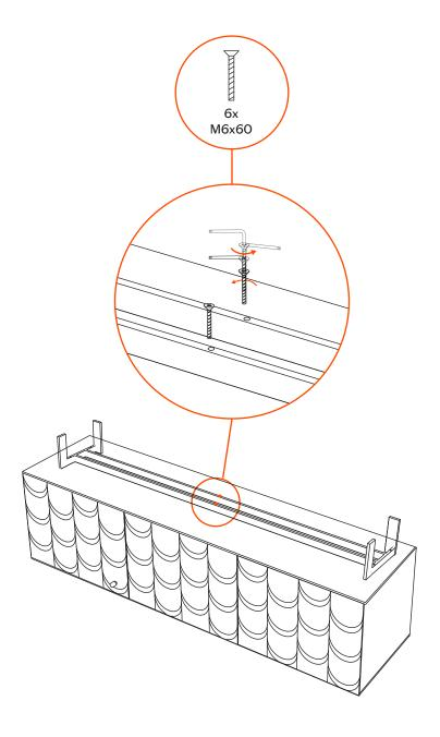
Avvitare la base sul corpo dell'armadio. Fai lo stesso sul lato sinistro e destro della base. | Screw the base to the cabinet's body. Do the same on the left and right side of the base.
