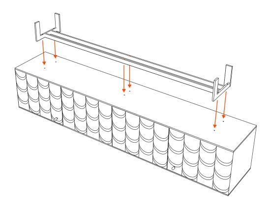
Posizionare la base sul corpo dell'armadio (sottosopra). Place the base to the cabinet's body (upside-down).
